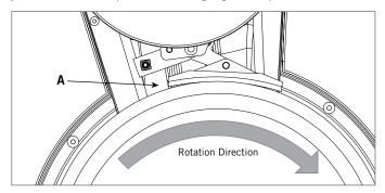
d. Replace brake pad if necessary
